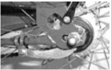
Drei-Gang-Nabenschaltung mit Bremsarmbefestigung am Rahmen
