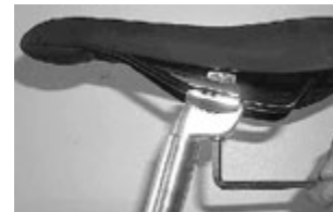
Patentsattelstütze mit Inbussbefestigung
